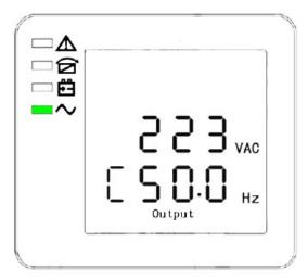
PHASE C (L3) OUTPUT VOLTAGE / FREQUENCY
