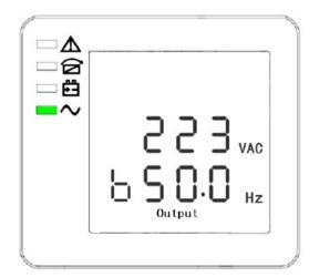
PHASE B (L2) OUTPUT VOLTAGE / FREQUENCY
