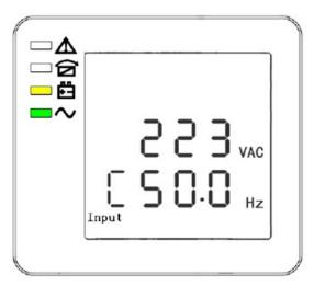
PHASE C (L3) INPUT VOLTAGE / FREQUENCY
