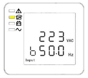
PHASE B (L2) INPUT VOLTAGE / FREQUENCY
